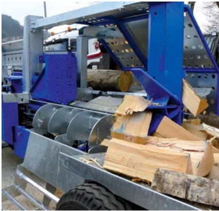
Présenté sur le stand d'ACI : le scieur fendeur Gigant de Binderberger, qui fend des bois jusqu'à 80 cm de diamètre et 1,25 m de longueur, avec une poussée de 40 tonnes.
